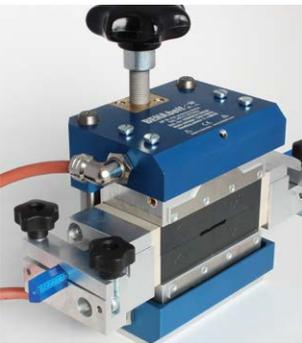
Den Formschuh mit Profil in die Heißpresse einsetzen: Längs mittig einsetzen. Die Nuten im Formschuh und die Nuten im Gehäuseoberteil und -unterteil müssen sich überdecken. In der Länge den Formschuh vermittelt zu den Heizplatten einlegen.
