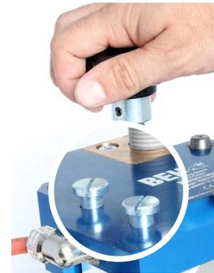
Durch Rechtsdrehen der Sterngriffschraube die obere Heizplatte nach unten stellen, bis sie Kontakt mit dem Formschuh hat. Anschließend Sterngriffschraube weiter drehen, bis sich die Schraubenköpfe 3-4mm von der oberen Gehäuseplatte abheben.
