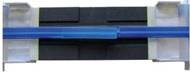
Die beiden Enden mittig einlegen und seitlich mit den Klemmschrauben befestigen. Die beschneittenen Riemenenden liegen dabei bündig überlap-pend übereinander. Die eingefrästen Nuten des Formschuhs zeigen die Mitte des Ober- und Un-terteils.
