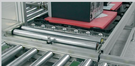
jednotku realizovat delší úseky segmentů. Kromě toho se zlepšilo chování systému při zrychlování a brzdění. To zvyšuje přesnost polohování a tím i bezpečnost, protože je zamezeno kontaktu citlivého zboží s válečkovým dopravníkem.
