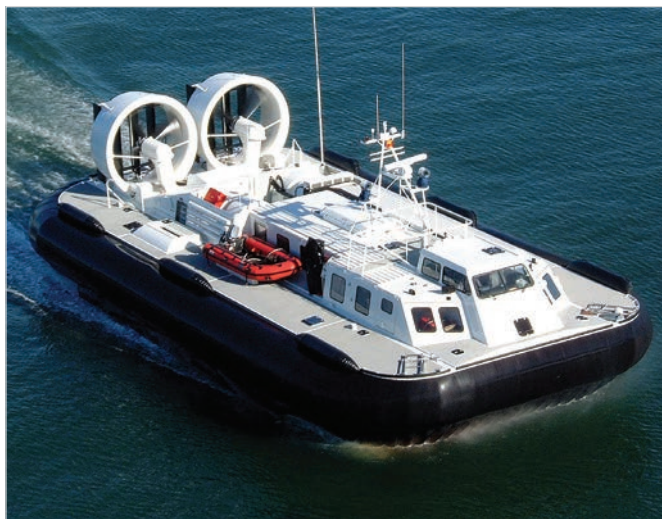
Obří vznášedlo Griffon Hoverwork je vybaveno dvěma vrtulemi a ventilátory, které jsou poháněny ozubenými řemeny Synchrochain Carbon. Foto: Griffon Hoverwork
