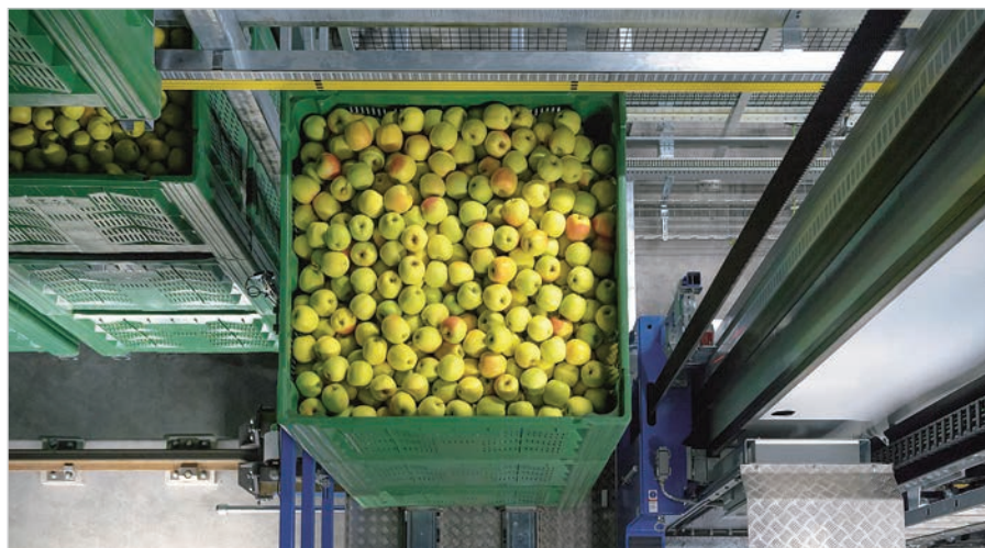
Ve 28 m vysokých skladovacích systémech zajišťují pohony s řemeny Conti Synchrodrive HTD 20M hladkou dopravu beden s jableky.
