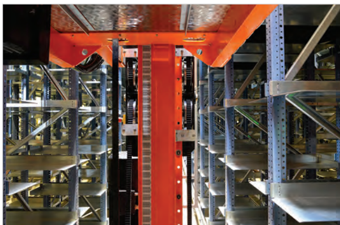
Budoucí technologie pro sklady s vysokými regály: ozubené řemeny Synchrodrive se vyznačují minimálním opotřebením, nižšími nároky na údržbu a delšími intervaly výměny. (Foto: LTW Intralogistics)
