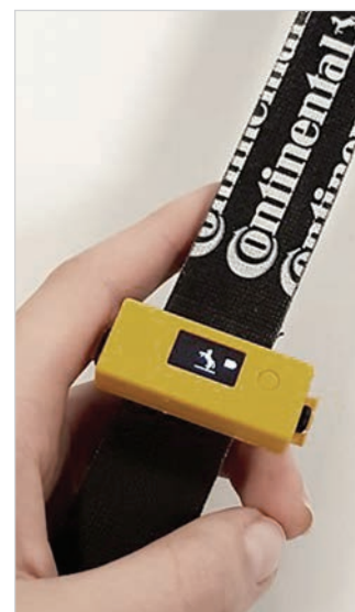
Měřicí přístroj VSM Mini pro kontrolu správného předpětí
