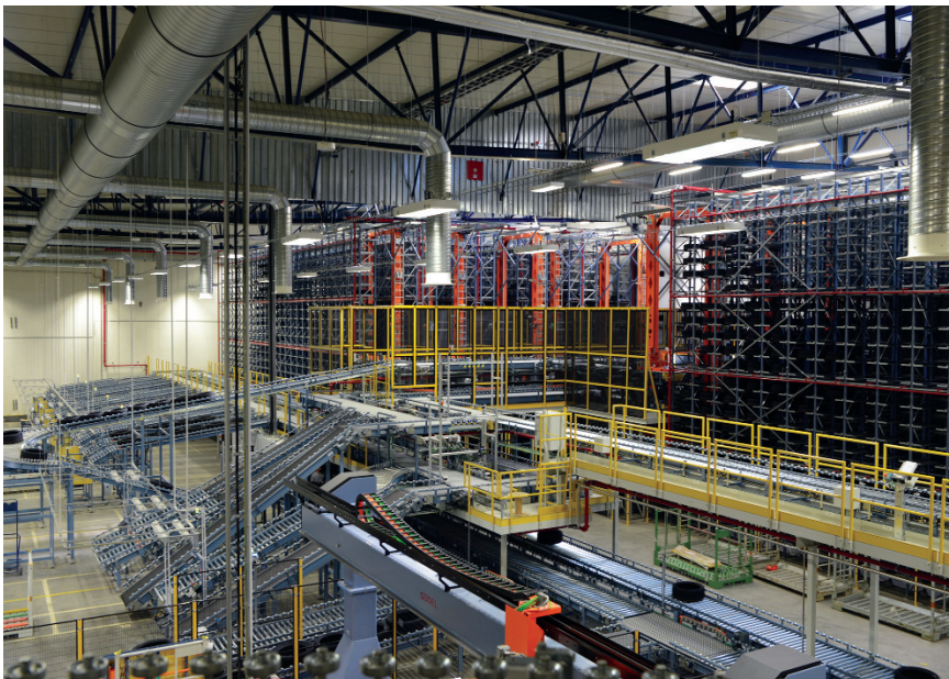
Nejmodernější vysokoregálovým skladem v továrně Continental v Otrokovicích v České republice prochází denně 16 000 pneumatik.
