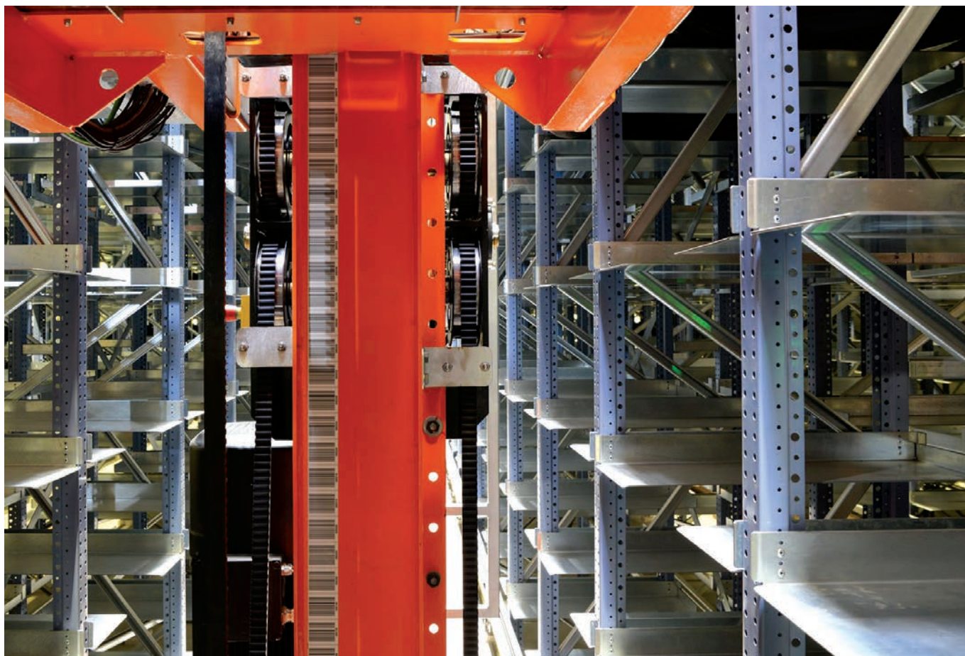
Budoucí technologie pro sklady s vysokými regály: ozubené řemeny Synchrondrive se vyznačují minimálním opotřebením, nižšími nároky na údržbu a delšími intervaly výměny.
